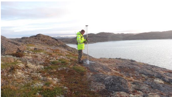
Indmåling af paspunkt til fotoflyvning. Foto: MRN. Opsendelse af drone. Foto: MRN.
